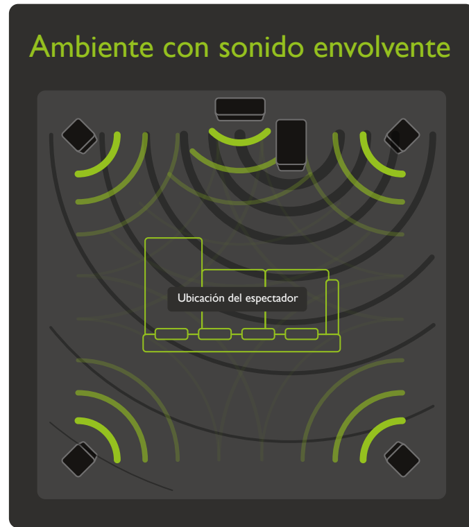
Disposición del sistema de parlantes de 5.1 canales
