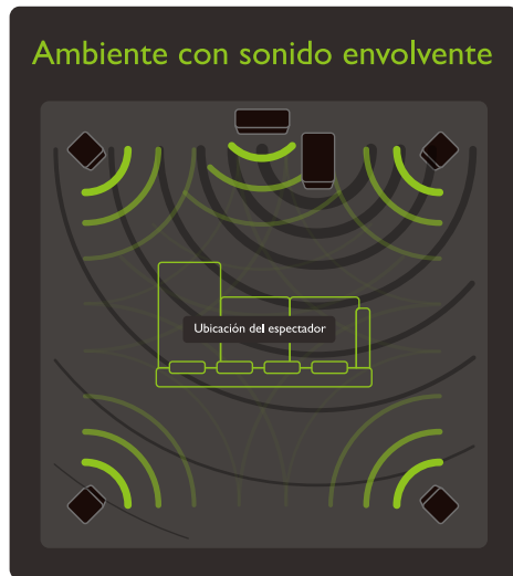
Disposición del sistema de parlantes de 5.1 canales
